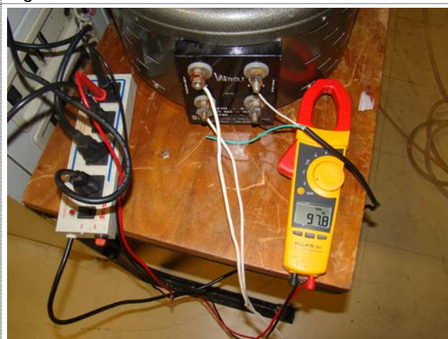
Figura 4: Configuração inicial da polarização: -15% da tensão nominal.
